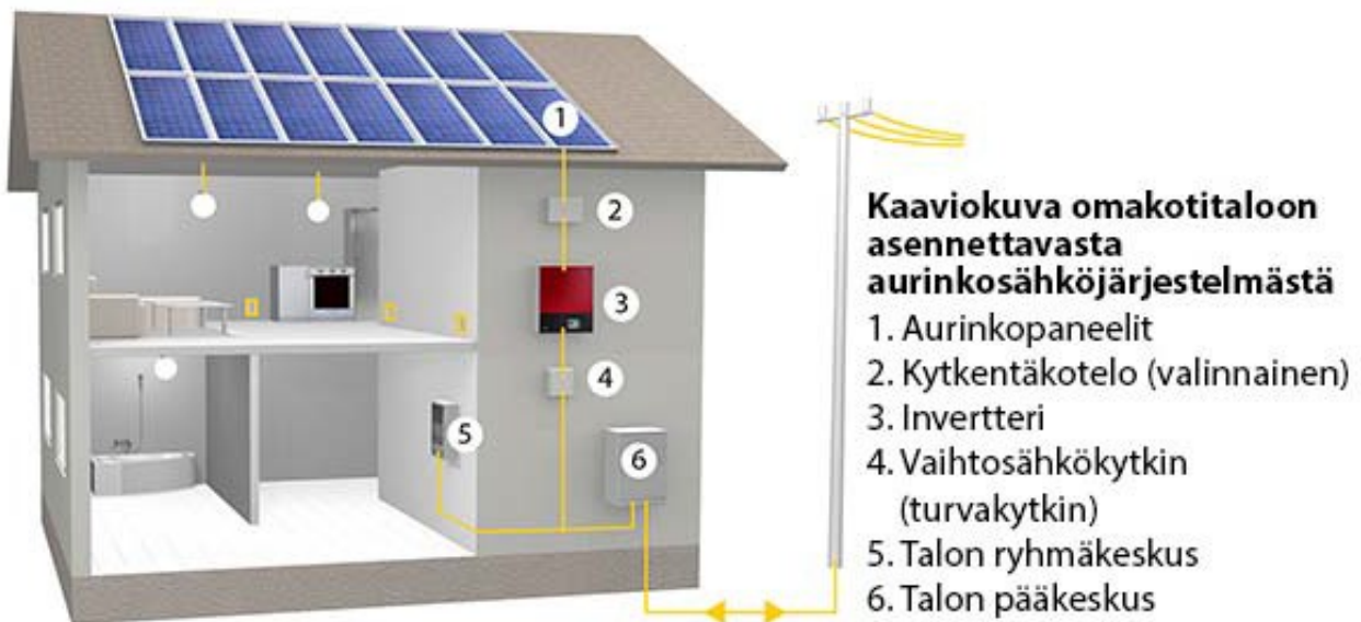
Kuva 1. Periaatekuva yleisen jakeluverkon rinnalla toimivasta aurinkovoimalasta.
