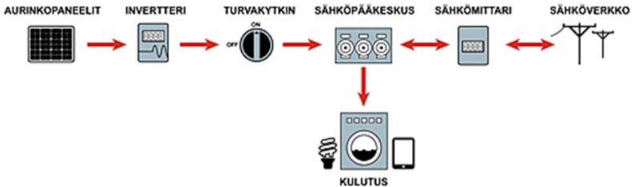
Kuva 2. Verkkoon kytketyn pientalon aurinkosähköjärjestelmän kokoonpano
